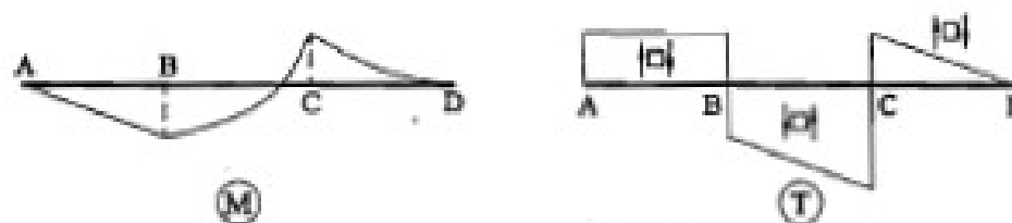
Fig. 5.16: Diagramas de esfuerzo cortante y momento flector para el ejemplo 8.
