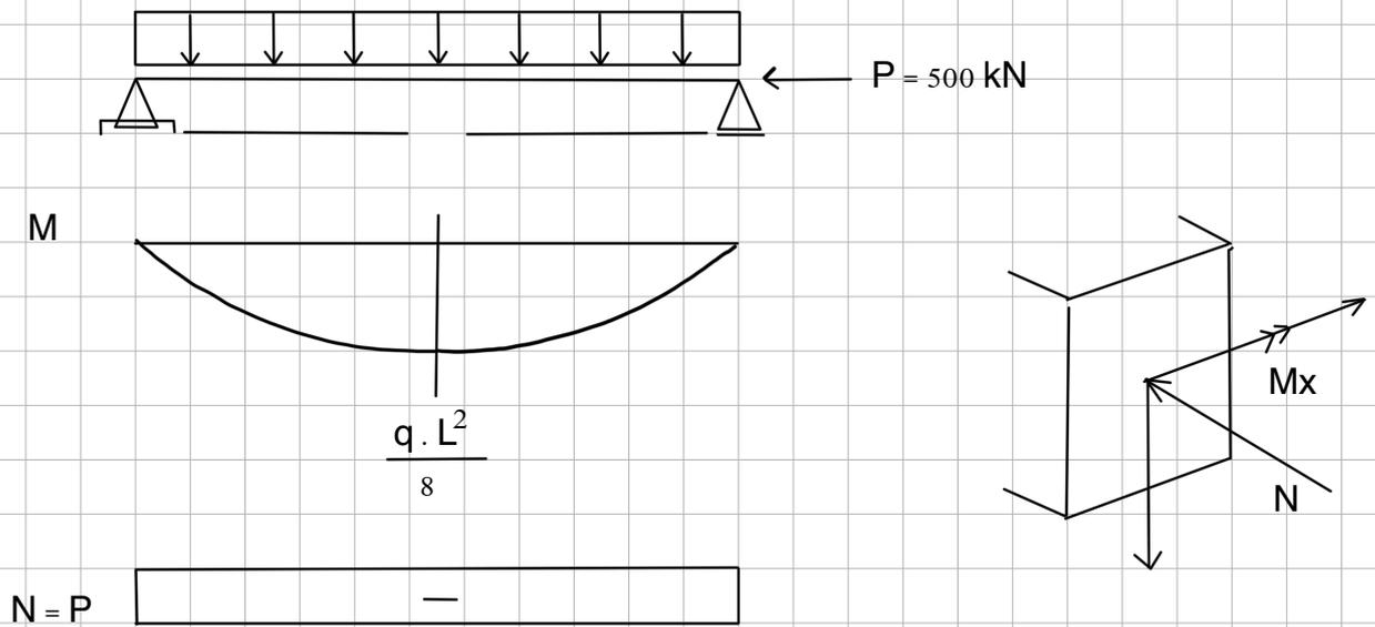
Vale el principio de superposición de efectos (PSE), entonces se puede pensar como las sumatoria de las tensiones generadas por el esfuerzo normal y las generadas por el momento
