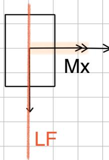
Eje neutro: eje respecto del cual no hay deformaciones  $\Rightarrow \sigma = 0$
