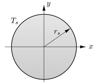
Hallar y graficar la temperatura en función del radio  $T(r)$  (en particular determinar la temperatura  $T_e$  en el eje del cilindro) y calcular el flujo de calor disipado por unidad de longitud  $q^*$  a través de la superficie del cilindro.
