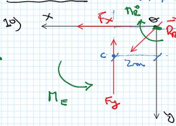
Condición nec. y suficiente para el equilibrio de un cuerpo rígido
