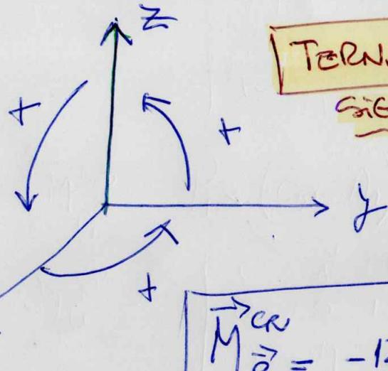
$$\begin{aligned} M_{P_x}^{P_y} &= -|P_y| \times 3m \\ M_{P_y}^{P_x} &= \text{NULO} \cdot P_y // y \\ M_{P_z}^{P_y} &= -|P_y| \cdot 3m \end{aligned}$$
