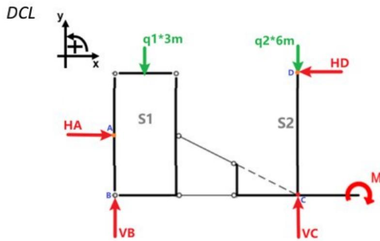
Medidas en metros.  $M=20\text{kNm}$ ,  $q=5\text{kN/m}$ .
