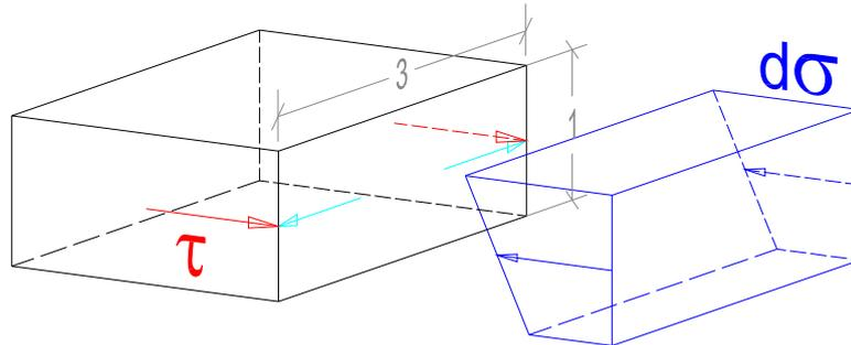
Recordemos que la deducción de la teoría de Jourawsky se basa en calcular las tensiones tangenciales dibujadas en rojo a partir del equilibrio con las tensiones  $d\sigma$  causadas por el  $dM$ . Luego se calculan las tensiones dibujadas en cyan, que por la teoría de Cauchy son iguales en módulo a las rojas. Por lo tanto la manera que se deduce el sentido de las tensiones sale del equilibrio esquematizado en la figura de arriba.
