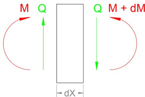
Los momentos generan ' $\sigma$ ' como vimos en flexión. Entonces tenemos de ambos lados diagramas de ' $\sigma$ ' cuyo eje neutro pasa por el baricentro (el eje neutro de una flexión no compuesta en régimen elástico es siempre baricéntrico).
