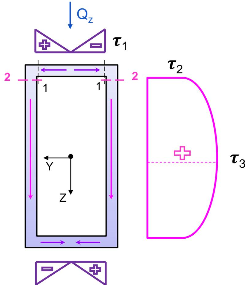
Si cortamos en la sección 1-1 podemos analizar cómo será el flujo de tensiones
