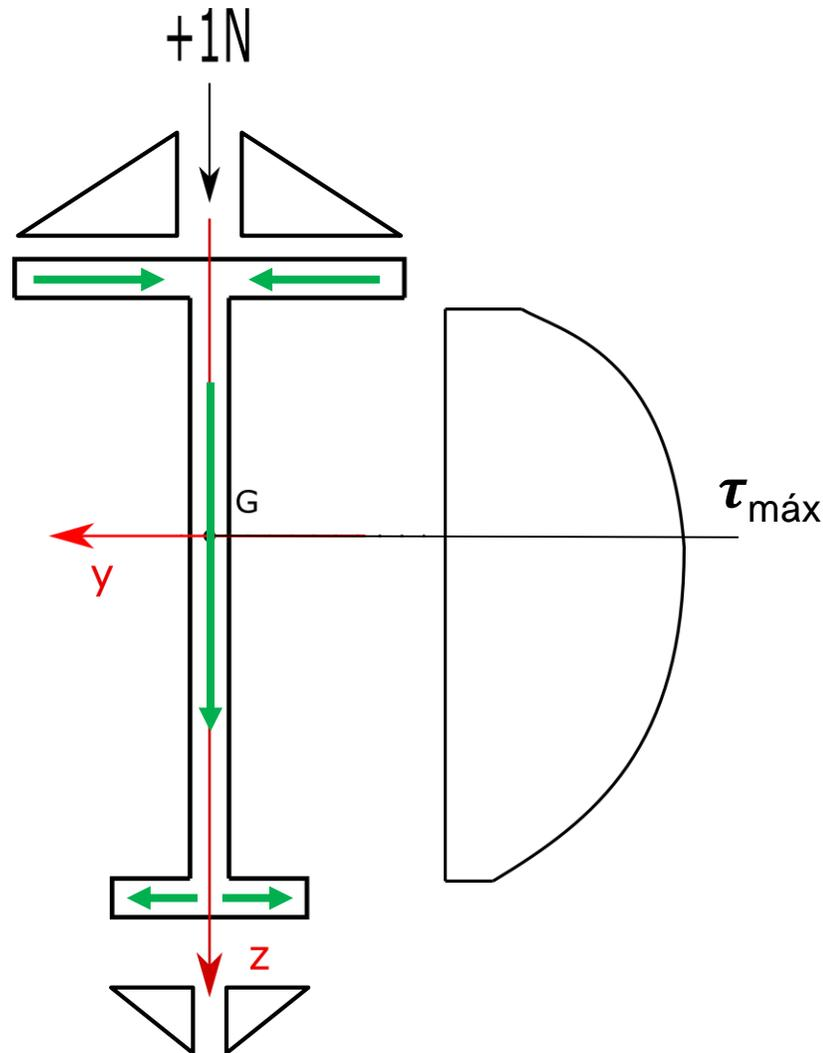
Como las tensiones de las alas se anulan entre sí, no se forma ninguna cupla que genere momento, por lo tanto la distancia al centro de corte en la dirección "y" es cero. Esto ocurre porque el eje "z" es el eje de simetría de la sección
