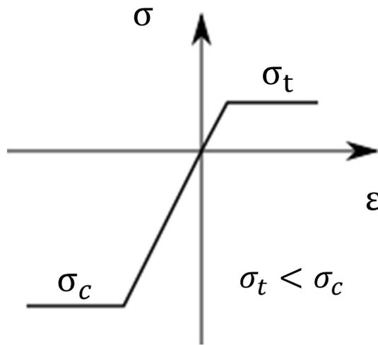
Al aplicar un esfuerzo axial de compresión, disminuirán las tensiones de tracción debidas a la flexión, haciendo que la sección resista un momento mayor al momento de plastificación total calculado para flexión simple.
