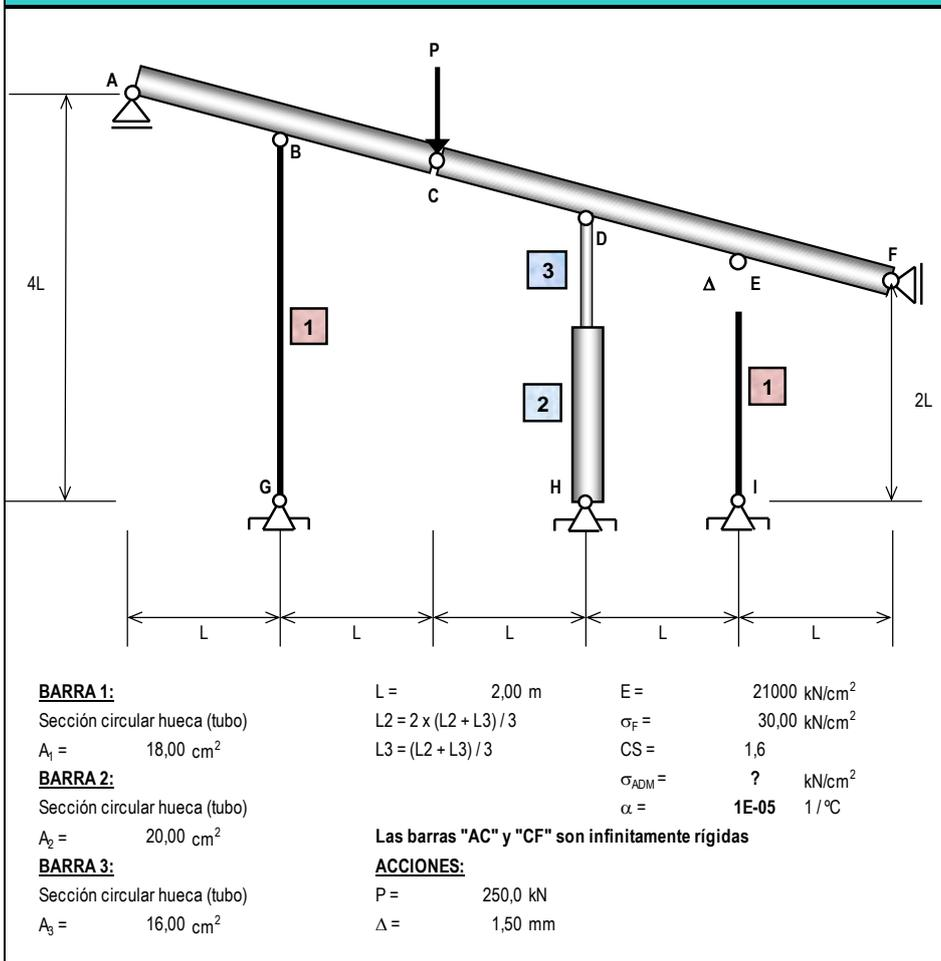
**NOTA:** Todo lo anterior deberá ser resuelto por "inspección" y por aplicación del "Método de las Incógnitas Estáticas" y el "Teorema de los Trabajos Virtuales".
