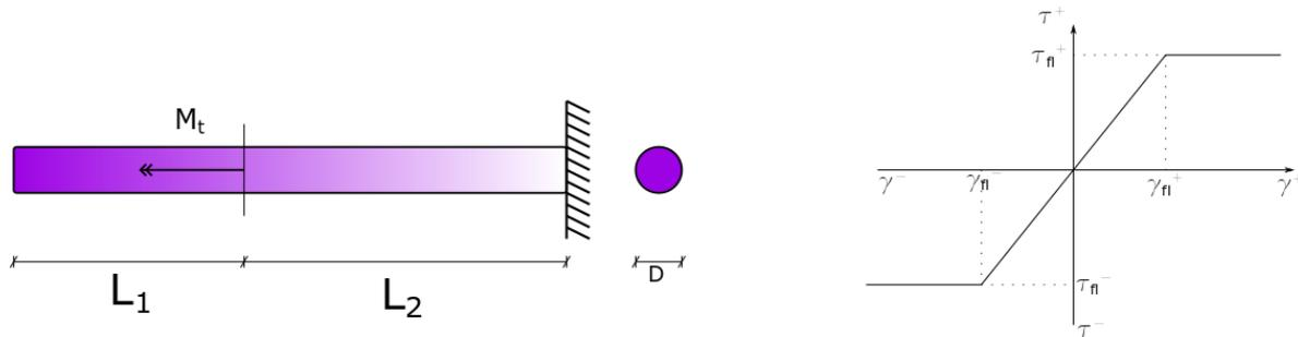
**EJERCICIO N° 5:** Un cilindro de material A ( $G_A = 38 \text{ GPA}$ ,  $\tau_{fl}^A = 160 \text{ MPa}$ ) de 8 cm de diámetro se encuentra dentro de un tubo de material B ( $G_B = 80 \text{ GPA}$ ,  $\tau_{fl}^B = 145 \text{ MPa}$ ) de 2 cm de espesor. Calcular el par torsor y la curvatura que es necesario aplicar para que se plastifique la totalidad del tubo de material B. Calcular tensiones residuales y curvatura residual, si se descarga la pieza.
